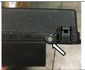
36. Insert grommet into slot.
